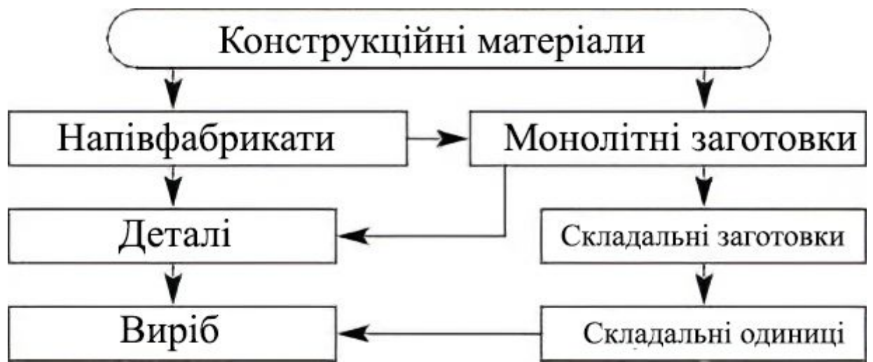
Рис. 1. Схема перевтілення конструкційних матеріалів в вироби машинобудування
